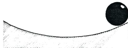
Wird der elastische Körper eines festen, flüssigen oder gasförmigen Stoffes aus seiner Gleichgewichtslage gebracht, so kehren seine Masseteilchen nicht einfach in diese zurück, sondern führen an der Störungsstelle hin- und hergehende Bewegungen, Schwingungen, um die Gleichgewichtslage aus (Abb. 219).
